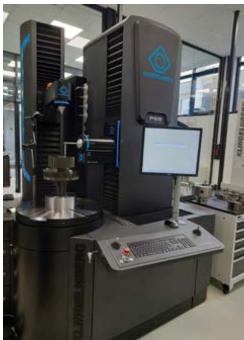
La sala metrologica, recentemente riattrezzata, è equipaggiata con il nuovo evolventimetro Klingelberg P65 con tecnologia ibrida, tattile e ottica
