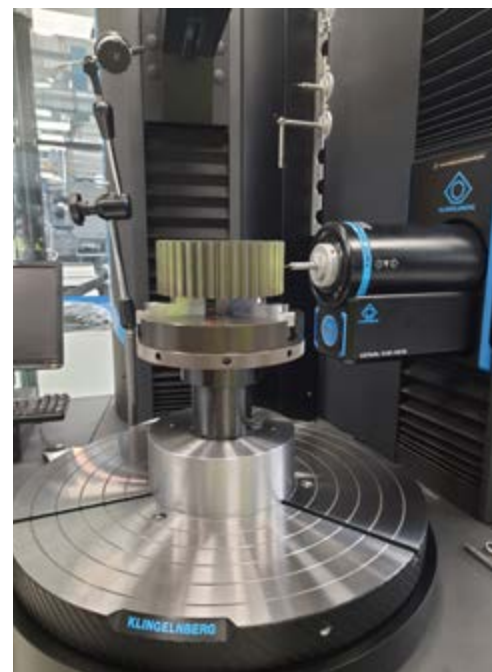
La sala metrologica, recentemente riattrezzata, è equipaggiata con il nuovo evolventimetro Klingelberg P65 con tecnologia ibrida, tattile e ottica
